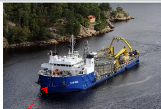
海底送電ケーブル敷設専用船(2)
