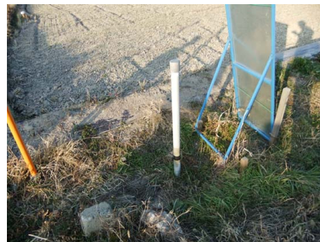
地下水の観測井
