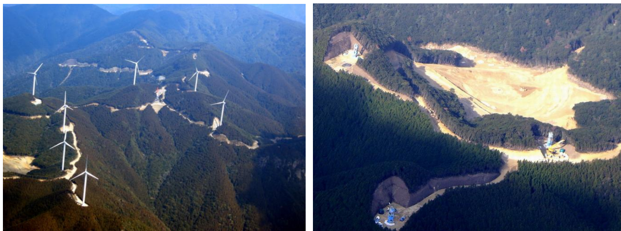
図2 尾根伝いに風力発電所の付設及び取付道路の建設による土地改変の例（A風力発電所） 8
